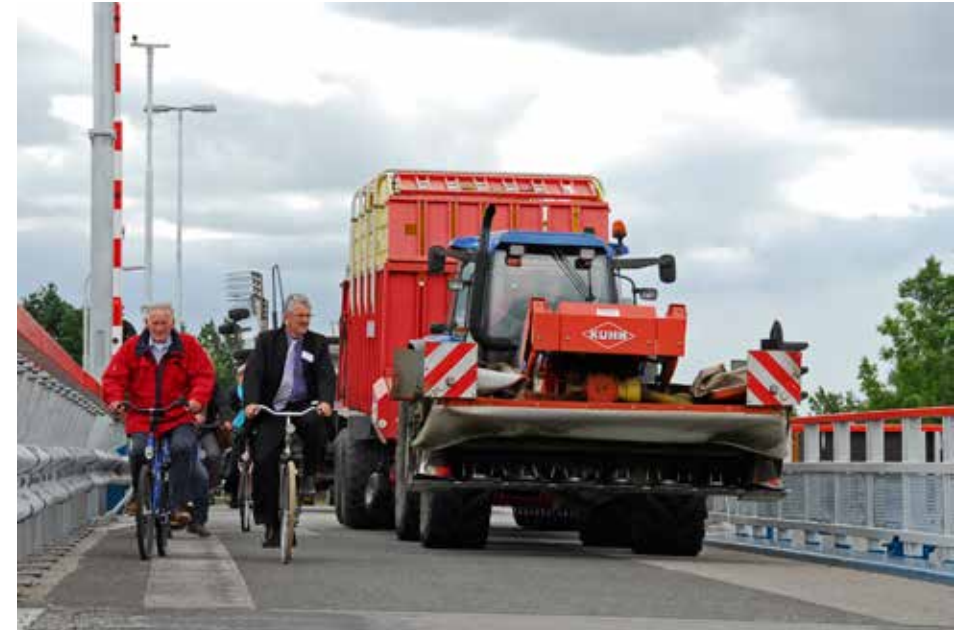
Markeringsborden zijn verplicht op verwisselbare uitrustingsstukken die meer dan 10 cm buiten de zijkant van de trekker uitsteken.
